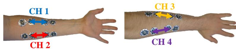
**Abbildung 5.18:** Elektrodenplatzierung für eine 4-Kanal-Messung unter Verwendung aller zur Verfügung stehenden Messmodule.
